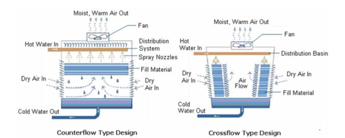
FIGURE - 11 TYPES OF COOLING TOWER
