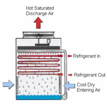
FIGURE - 10 EVAPORATIVE CONDENSER
